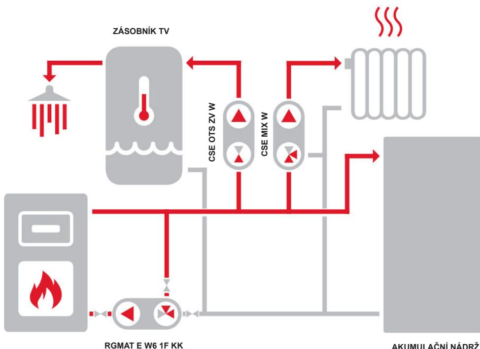
Schéma zobrazuje typické zapojení kotle na tuhá paliva, akumulační nádrže a otopného okruhu (s doporučenou čerpadlovou skupinou CSE MIX W - není součástí dodávky). Pokud je kotel využíván také pro přípravu TV, doporučujeme instalovat čerpadlovou skupinu CSE OTS ZV W (není součástí dodávky).
